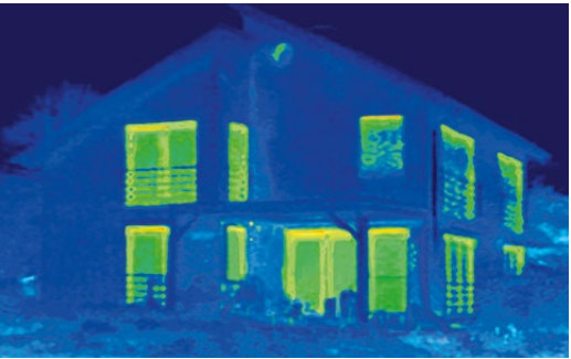
Po fachowo przeprowadzonej wymianie okien na system okienny Schüco LivIng zdjęcie termograficzne pokazuje znaczący efekt energetyczny takiej inwestycji: pierwotna strata energii została prawie całkowicie zniwelowana
